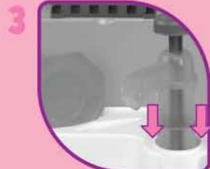
1º Encaje a bomba no orificio circular. Note que a bomba gira da cuba até o escorredor.
